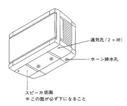
②このスピーカを設置する場合は、下図の様に俯角(下 向き角度)が必ず0°(水平)~45°(下向き)の範囲内で 設置してください。(上向きの設置は避けてください。)
